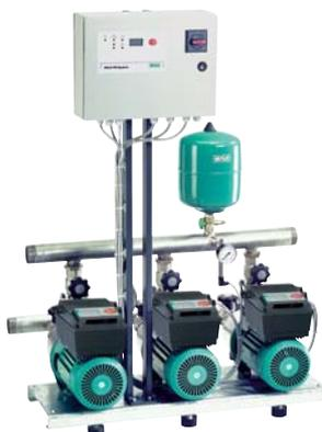
Surpresseurs avec 2 à 6 pompes multicellulaires en acier inoxydable non auto-amorçantes installées en parallèle et avec régulation de vitesse.
